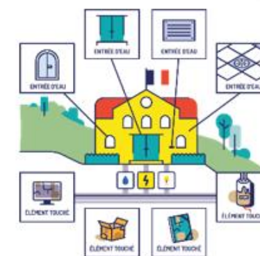
Figure 19 : Les différentes entrées d'eau d'une habitation et les éléments touchés par les eaux des inondations.
