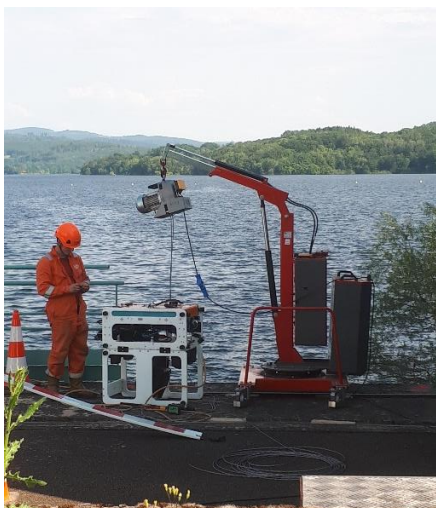
ROV de différents gabarits mobilisés lors de l'inspection
