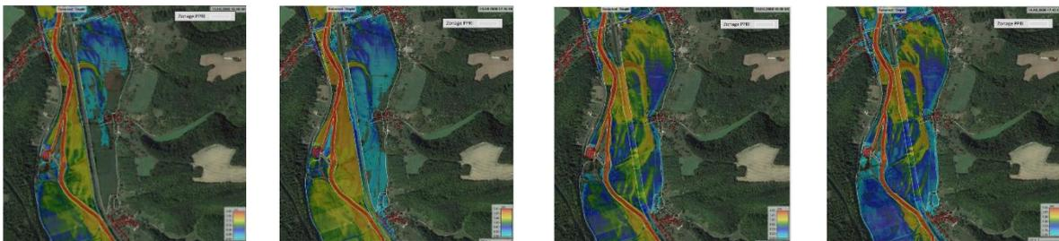
Exemple modélisation avec la digue à gauche et sans digue (T10 et T100)
